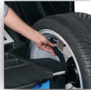
◀ 专利平衡块安装头 使得粘贴式平衡块的安 装变的简便易行
