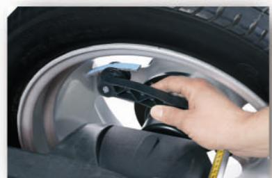
测量臂整合粘贴式平衡块安装头(专利)使得安装粘贴式平衡块更简便易行
